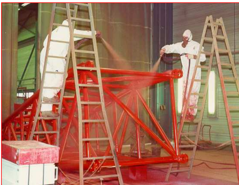
Pav. 3. Elektrostatinio dažymo privalumai labiausiai matomi dažant vamzdynus ar erdvines konstrukcijas.
